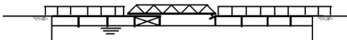
Figuur 3.16: Schets zij aanzicht uitschuifbare brug
